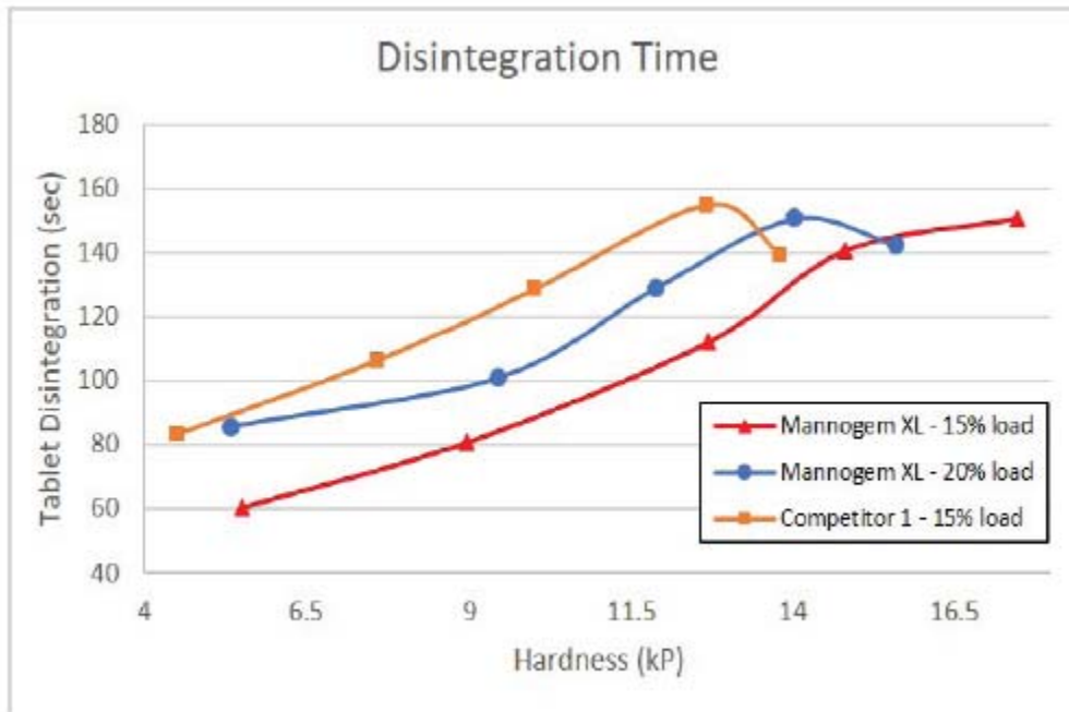
图2.非直压APAP不同载药量的硬度与崩解时限
